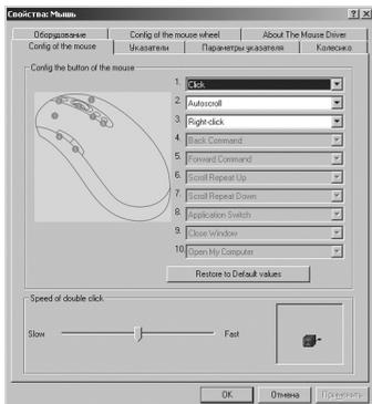
Двойным щелчком на пиктограмме мышки Вы открываете интерфейс настройки "Свойства: Мышь". Управляющие элементы для дополнительных настроек находятся на листах "Config of the mouse" (конфигурация кнопок мыши) и "Config of the mouse wheel" (конфигурация колеса прокрутки мыши).
